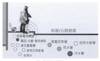
图4 管线探测模块 图片来源: http://www.conic.com.tw/
